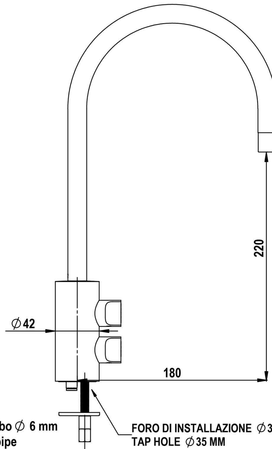
FORO DI INSTALLAZIONE  $\phi$  35 MM
