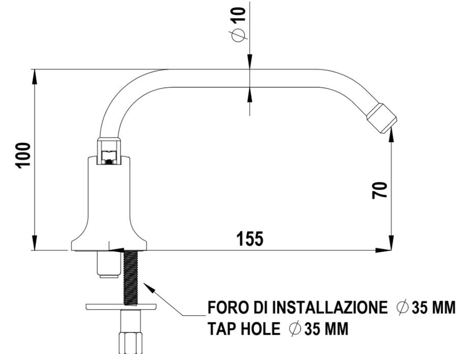
FORO DI INSTALLAZIONE  $\phi$  35 MM
