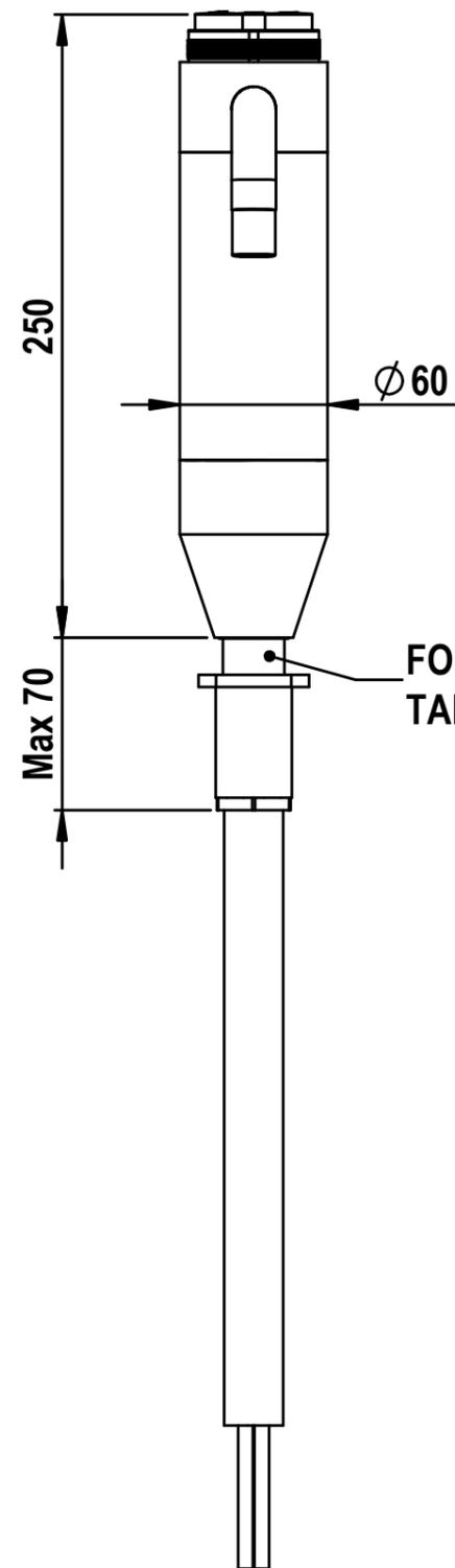
FORO DI INSTALLAZIONE  $\phi$  26 MM
